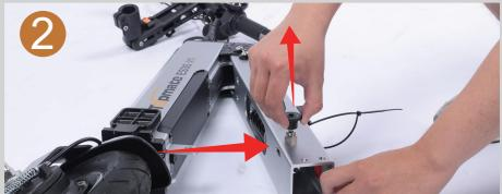
Heben Sie die Faltschnalle an und klappen Sie die Rollerkarosserie auf.
