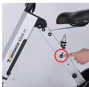
1.Tirez sur la boucle de verrouillage vers l'extérieur et dépliez le corps du scooter.
