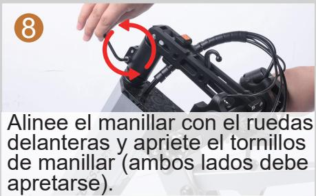
Alinee el manillar con el ruedas delanteras y apriete el tornillo de manillar (ambos lados deben apretarse).
