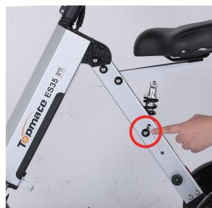
1.Tirare la fibbia di blocco verso l'esterno e dispiegare il carrozzeria dello scooter.
