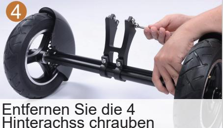
Entfernen Sie die 4 Hinterachsschrauben
