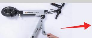
Use las cuerdas para ayudar a levantar el soporte del cojín del asiento para Completar el proceso de despliegue (este paso puede requerir fuerza)
