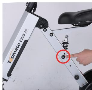
1. Ziehen Sie die Schlossschnalle nach außen und klappen Sie die Karosserie des Rollers auf.
