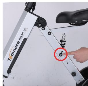
1. Tire de la hebilla de bloqueo hacia afuera y despliega el cuerpo del scooter.
