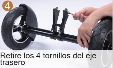
Retire los 4 tornillos del eje trasero
