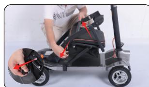
4. Coloque su mano en la parte de la viga central del soporte del respaldo y levántela hasta que salga el pasador del límite del asiento, al mismo tiempo que puede escuchar el sonido de "crujido", luego intente empujar el asiento hacia adelante para asegurarse de que el asiento ya no se pliega.
