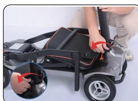
2. Loosen the locking bolt.
