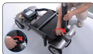
3. Hay dos ángulos para elegir. Despues de levantar la manija de dirección y ajustarla ligeramente a un ángulo cómodo, apriete el perno de bloqueo. (El perno de bloqueo está ubicado al opuesto del pasador de límite plegable).
