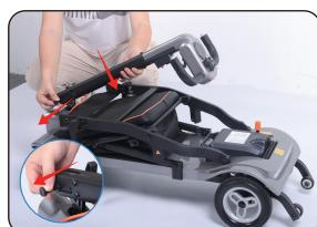
1. Tirez sur la goupille de fin de course du siège et poussez le siège vers l'avant pour qu'il se rabatte.
