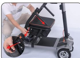
1. Tirare il perno di fine corsa del sedile e spingere il sedile in avanti fino a ribalzarlo verso il basso.
