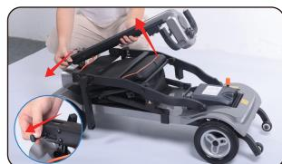
2. Tirare il perno a molla e fare in modo che la maniglia dello sterzo si alzi a 90 ° allo stesso tempo, è possibile sentire il suono "crack".
