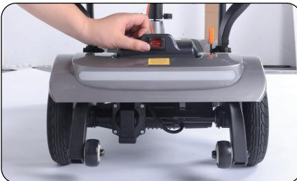
1. Stellen Sie sicher, dass sich der Netzschalter im ausgeschalteten Zustand befindet
