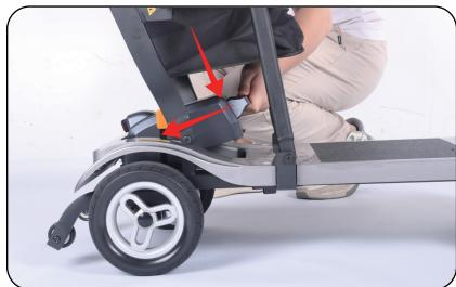
2. Fassen Sie den Batteriegriff und schieben Sie den Akku nach innen. Wenn die Batterie in die innerste Position gedrückt wird, lassen Sie die Hand los und die Batterie springt automatisch zurück, dann ist die Batterieinstallation abgeschlossen.
