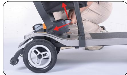
2. Fassen Sie den Batteriegriff, schieben Sie den Akku nach innen und heben Sie ihn an, dann wird der Akku herausgenommen.
