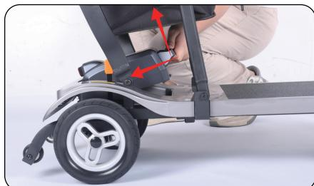
2. Agarre el mango de la batería, empuje la batería hacia adentro y levántela, luego se sacará la batería.
