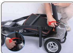
2. Lösen Sie den Verriegelungsbolzen.
