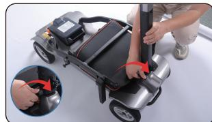
3. Es stehen zwei Winkel zur Auswahl. Nachdem Sie den Lenkgriff angehoben und in einen bequemen Winkel gebracht haben, ziehen Sie dann den Verriegelungsbolzen fest. ( Der Verriegelungsbolzen befindet sich gegenüber dem Klappanschlagbolzen).
