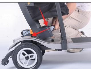
2. Sujete el mango de la batería y empújela hacia adentro. Cuando se empuja la batería a la posición más interna, sáquela con la mano y la batería rebotará automáticamente, luego finalizará la instalación de la batería.
