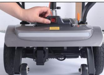
1. Asegúrese de que el interruptor de encendido esté en estado APAGADO
