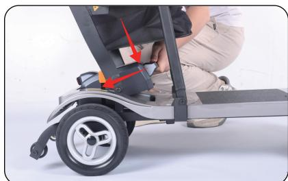
2. Saisissez la poignée de la batterie et poussez la batterie vers l'intérieur. Lorsque la batterie est poussée vers l'intérieur, quittez la main et la batterie rebondira automatiquement, puis l'installation de la batterie est terminée.
