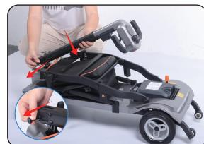
3. Ziehen Sie den Federstift des Lenkgriffs und drehen Sie den Lenkgriff gleichzeitig nach unten, dann verriegelt er automatisch.
