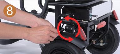
Montieren Sie den hinteren Kotflügel (ziehen Sie die Schrauben gegen den Uhrzeigersinn fest)
