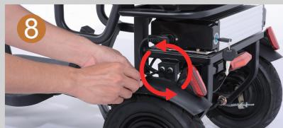
Installare il parafango posteriore (serrare le viti in senso antiorario per fissarlo)
