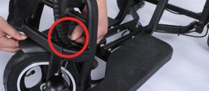
Installare il parafango anteriore, assicurandosi che l'estremità anteriore dello scooter sia inclinata di un angolo di 45° come mostrato nell'immagine.
