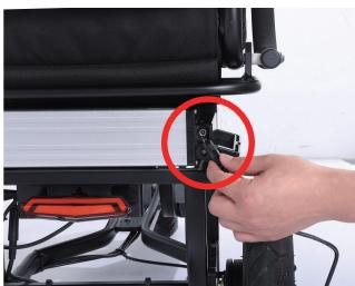
2.Suchen Sie den Ladeanschluss und schließen Sie das Ladegerät an.
