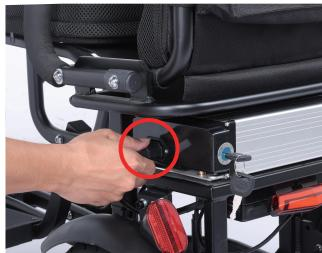
1.Alignez la batterie avec la chenille et insérez-la dans le scooter.
