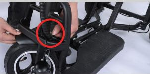
Montieren Sie den vorderen Kotflügel und stellen Sie sicher, dass die Frontpartie des Rollers in einem Winkel von 45° geneigt ist, wie auf dem Bild gezeigt.
