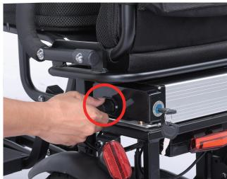
1.Richten Sie den Akku auf die Spur aus und setzen Sie ihn in den Scooter ein.
