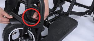
Installez le garde-boue avant, en vous assurant que l'extrémité avant du scooter est inclinée à un angle de 45°, comme indiqué sur l'image.
