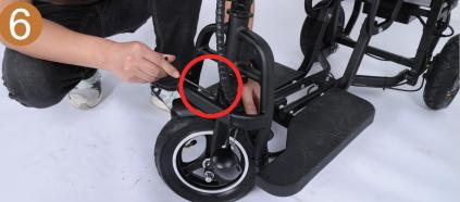
Serrez fermement les vis pour fixer le garde-boue avant en place.
