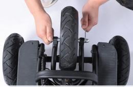
Ziehen Sie die Schrauben auf beiden Seiten fest, um die Vorderräder zu sichern
