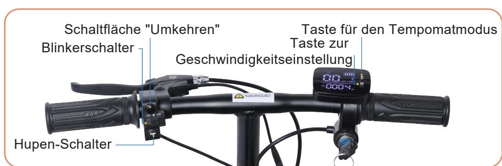
**Aktivieren Sie den Tempomat-Modus:** Halten Sie die Tempomattaste gedrückt, drehen Sie den Gashebel und lassen Sie ihn los, um ihn zu aktivieren. Im Tempomat hält der Roller eine Geschwindigkeit von 3 km/h (2 MPH).
