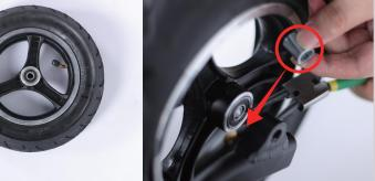
Installare la ruota anteriore e utilizzare l'attrezzo per inserire le viti del cuscinetto
