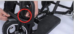
Instale el guardabarros delantero, asegurándose de que la parte delantera del scooter esté inclinada en un ángulo de 45 ° como se muestra en la imagen.
