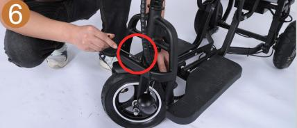
Serrare saldamente le viti per fissare il parafango anteriore in posizione.
