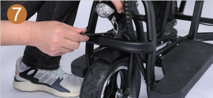
Montieren Sie das Frontlicht und ziehen Sie die Schrauben fest
