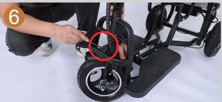
Ziehen Sie die Schrauben fest an, um den vorderen Kotflügel zu fixieren.
