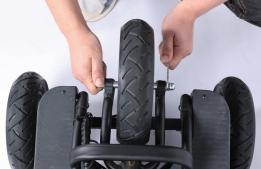
Serrez les vis des deux côtés pour fixer les roues avant
