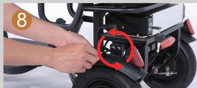
Installez le garde-boue arrière (serrez les vis dans le sens inverse des aiguilles d'une montre pour fixer)
