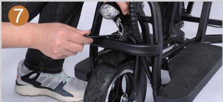
Instale la luz delantera y apriete los tornillos
