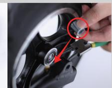
Instale la rueda delantera y use la herramienta para insertar los tornillos del cojinete
