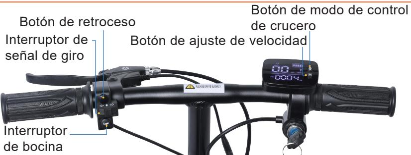
**Activar el modo de control de crucero:** Mantenga presionado el botón de control de crucero, gire el acelerador y suéltelo para activarlo.
