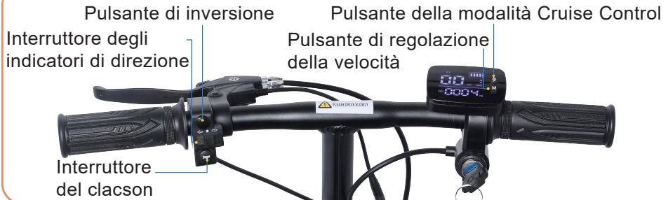
**Attiva la modalità Cruise Control:** Tenere premuto il pulsante del cruise control, girare l'acceleratore e rilasciarlo per attivarlo.
