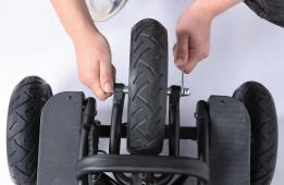
Apriete los tornillos de ambos lados para asegurar las ruedas delanteras
